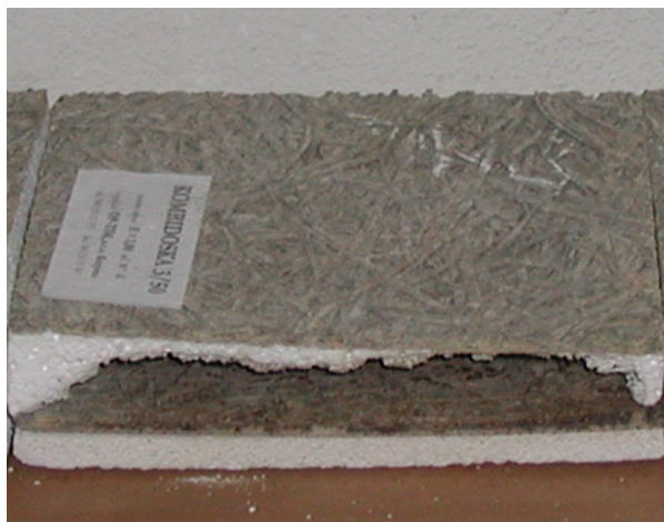
Obrázek 1: Polystyren byl aplikovaný mezi dvě cementotřískové desky, z jedné strany omítnuté (omítka 10 mm). Oheň působil ze strany omítky.
