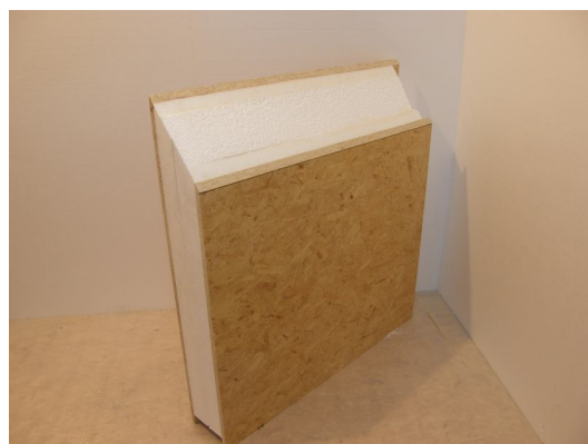
Obrázek 12: Dokončený upravený panel s hranou seříznutou pod úhlem.
