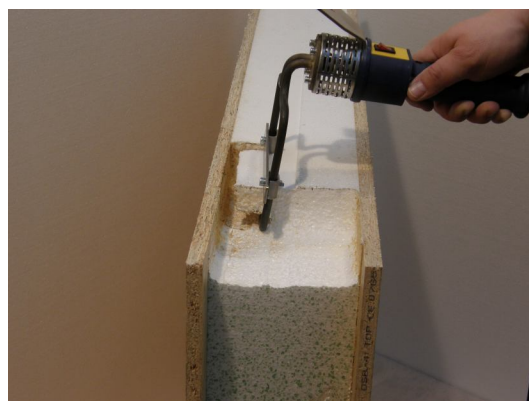
Obrázek 15: Vypalování kolmo na drážku.
